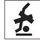
M3 10 Указывает места, где нельзя применять тельню при подъеме груза
